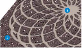
De FloorTattoo wordt in het Triflex systeem verwerkt. De kleur van de tussenlaag van het systeem zal de uiteindelijke kleur van de FloorTattoo worden. De definitieve afwerking aanbrengen op de Triflex Floortattoo. Zodra het volledige systeem is uitgehard, kan de folie verwijderd worden. Het patroon is zichtbaar als een negatieve afdruk.
